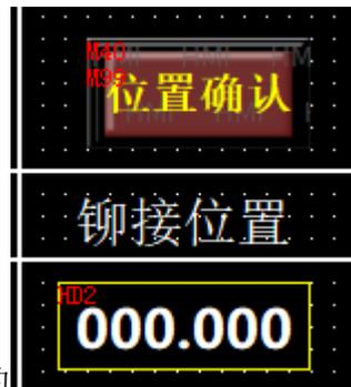
按住铆接位置上面的
