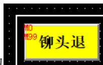
不要松手, 此时铆头会往上走, (如果速度太慢, 修改“铆接速度”的值。) 直到铆头不能往上移动为止, 此时铆头已复位归零松开按钮。
